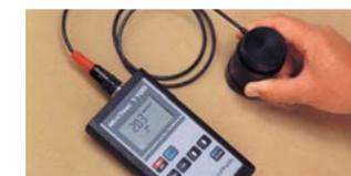
シートに特殊加工が施されており、探触子を接地するだけでウレタン塗膜を傷付けることなく膜厚を測定できます。
